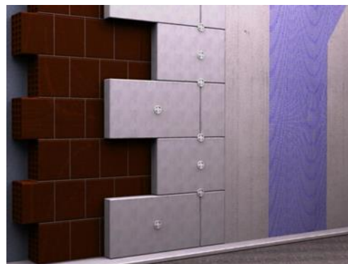
Figura 8.1 – Esempio tipo di coibentazione a cappotto
